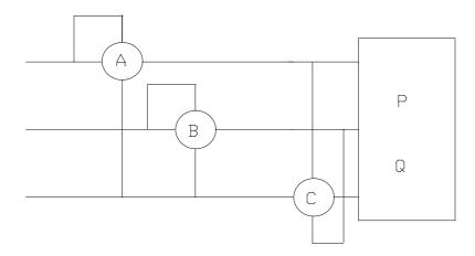
Si definisce inserzione in quadratura quando il circuito voltmetrico è derivato tra due fili differenti da quello in cui è inserito il circuito amperometrico.
