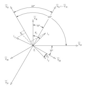
e proiettando le 3 correnti sull' asse  $V_{12}$ , la somma delle tre proiezioni dovrà essere  $0\,$  perché la somma delle tre correnti è uguale a  $0\,$
