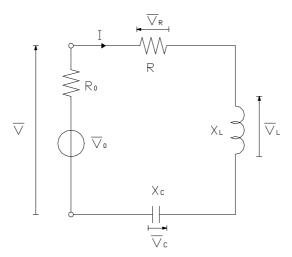
tale bipolo è alimentato da una tensione V con pulsazione  $\omega$  e impedenza interna  $R_{\rm 0}\,.$
