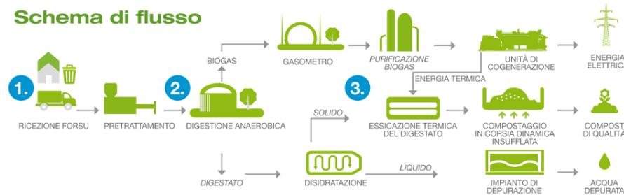
le e favorire la produzione del biogas il materiale all'interno dei digestori viene rimescolato in continuazione. Il biogas, così prodotto, esce costantemente dai digestori ad una pressione di 25 mbar, viene convogliato verso un primo trattamento di desolfurazione, per essere poi accumulato all'interno di un gasometro con funzione di serbatoio per l'alimentazione del cogeneratore. Dal gasometro il biogas viene avviato al cogeneratore per una produzione elettrica costante di 1MWh.
